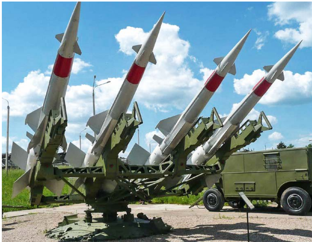
Das S-125 „Newa“ ist ein radargeleitetes Flugabwehrraketensystem, das in den Streitkräften des Warschauer Vertrags eingesetzt wurde.
