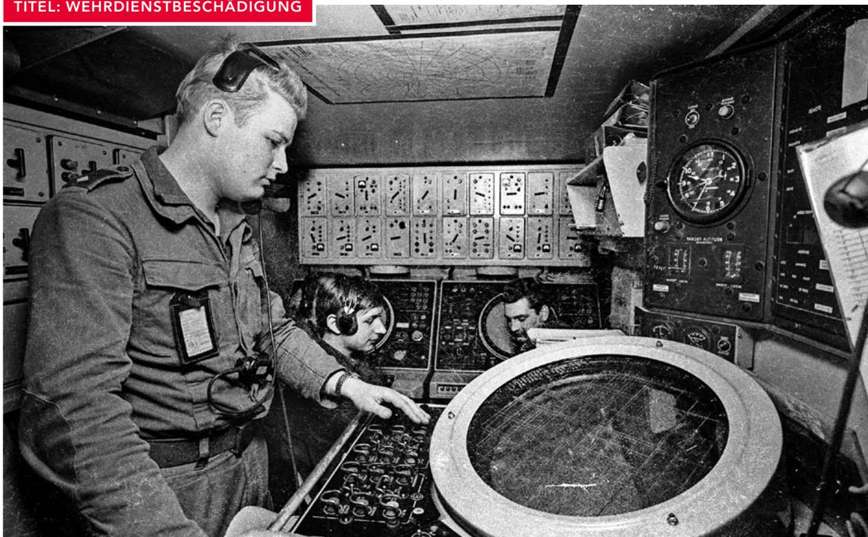
Eine Einheit der Bundesluftwaffe, ausgerüstet mit Flugabwehrraketen des Typs „Hawk“ in der Nähe von Delmenhorst in den 1970er Jahren. Ein Soldat kontrolliert am Radarschirm im AN/TSW-11 Battery Control Central (Feuerleitstand) der Batterie die Flugbewegungen.
